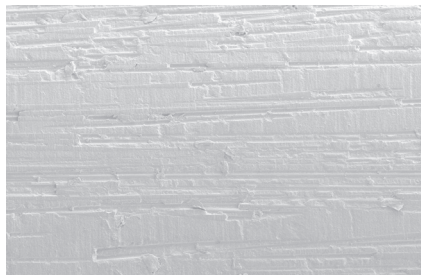
Imagen del microscopio electrónico de barrido (MEB) que muestra la superficie del poste TENAX Fiber Trans, a 400x.
